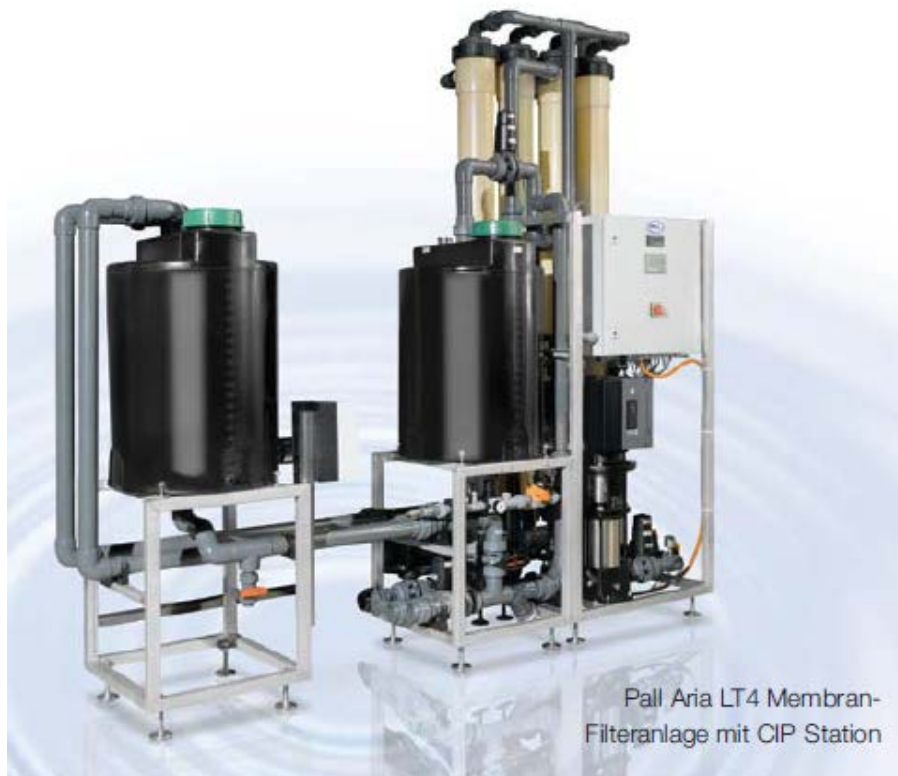
Bild 20: Produktbeispiel für OUT-IN-Filtration mit Wasser-Luft-Spülung als 4-Membranmodul-Anlage mit CIP-Station (Bild: Pall Corporation)
