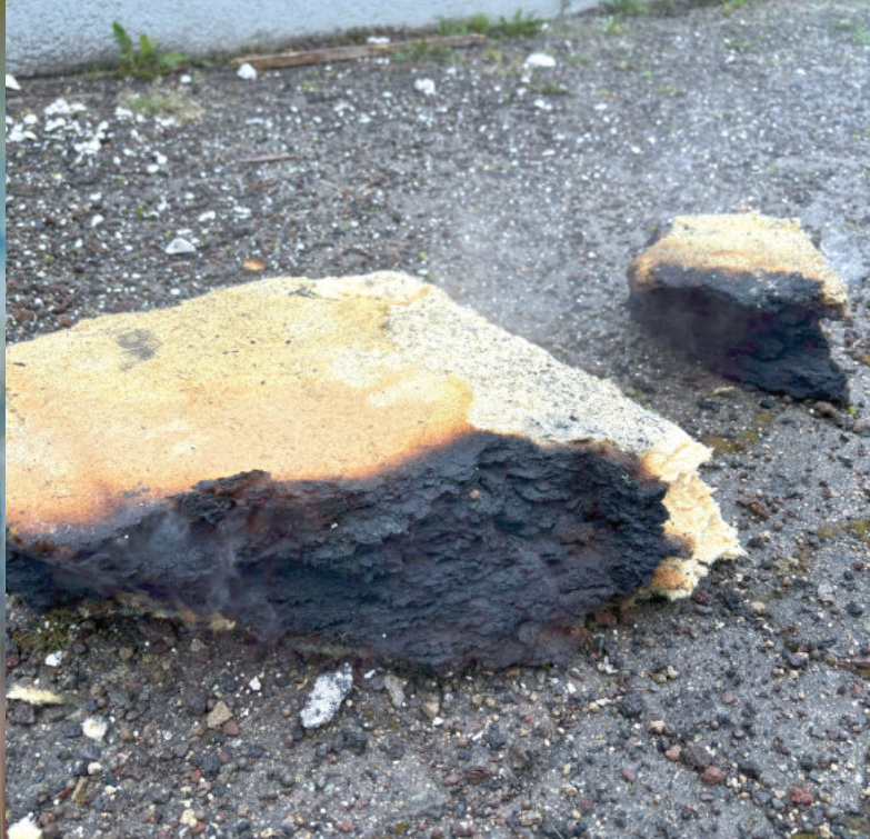
Abgetragene Reste der verbauten Holzfaserplatten mit Brandspuren. Bildquelle: Feuerwehr Donaueschingen
