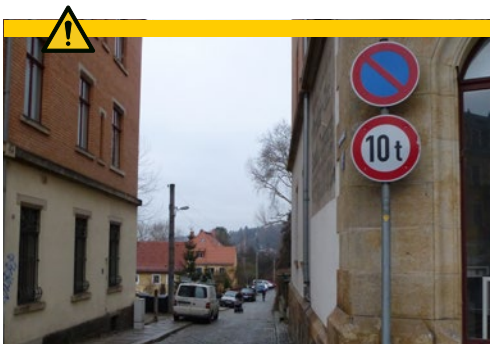
Abb. 1 Die Tragfähigkeit dieser Straße ist für ein „Standard-abfallsammelfahrzeug“ nicht ausreichend.
