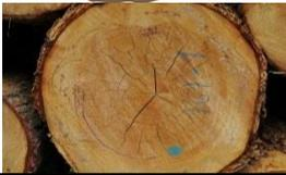
**16** **Weichfäule** wird von Mikropilzen verursacht, die Zellulose und Hemicellulose zersetzen und die Festigkeitseigenschaften des Holzes mindern. Sie tritt in fortgeschrittener Ausprägung flächig, oft zentrisch auf.
