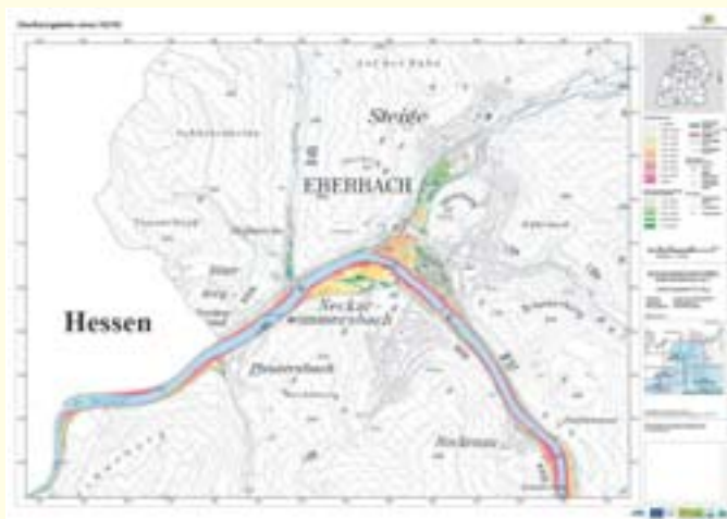
Standarddarstellung Typ 1 – Wassertiefen für Bemessungshochwasser HQ_{100}
