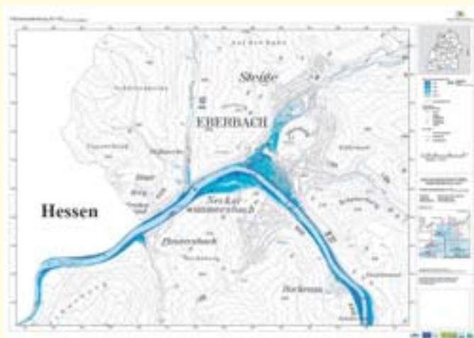
Standarddarstellung Typ 2 – Überflutungsflächen für verschiedene Wiederkehrintervalle
