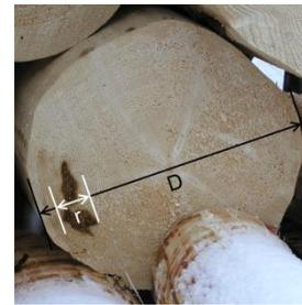
**16** **Weichfäule** wird von Mikropilzen verursacht, die Zellulose und Hemizellulose zersetzen und die Festigkeitseigenschaften des Holzes mindern. Sie tritt in fortgeschrittener Ausprägung flächig, oft zentrisch auf.
