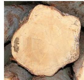
**17** Rückeschäden wird durch Zulassen von Weichfäule im äußeren Bereich des Wurzelanlaufs in Qualitätsklasse D Rechnung getragen. Vorausgesetzt, wird dass mindestens 80 % des Querschnitts über die gesamte Länge verwendbar sind.
