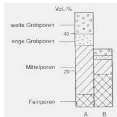
**Abb. 2: Gesamtvolumen und Porengrößenverteilung in einem ungestörten (A) und in einem umgelagerten Löß (B) am Kaiserstuhl**
