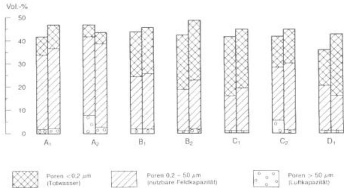
Abb. 5: Gesamtporenvolumen und Porengrößenverteilung ungestörter (1. Säule) und gestörter (2. Säule) Bodenproben nach Belastung mit  $60\text{N/cm}^2$  bei pF 1,8 (vgl. Tab. A2 bis A9)
