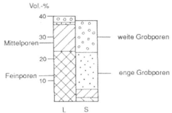
**Abb. 3 Gesamtvolumen und Porengrößenverteilung eines Lehmbodens (L) und eines Sandbodens (S) nach starker Belastung (60 N/cm<sup>2</sup>, vgl. Tab. A9)**
