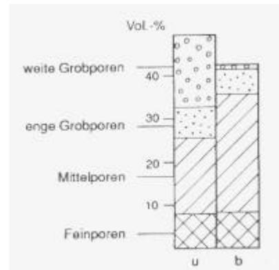
**Abb. 1: Änderung des Gesamtporenvolumens und der Porengrößenverteilung durch Verdichtung ungestörter Proben aus dem Oberboden einer Lößpararendzina**
