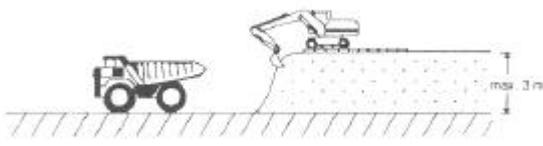
**Abb. 9: Ausbau von kulturfähigem Unterboden mit dem Tieflöfflbagger auf Baggermatratze**
