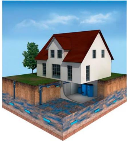
Geothermische Brunnenanlagen können bei genügend großem Wasservorkommen in geringer Tiefe (ca. 8 m bis 14 m) errichtet werden. Hierzu sind zwei Bohrungen notwendig, die zu einem Förder- und einem Schluckbrunnen ausgebaut werden. Dem geförderten Wasser wird die Wärme entzogen und das kalte Wasser anschließend über den Schluckbrunnen wieder in das Grundwasser eingeleitet.
